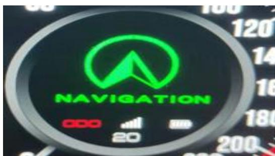
2. Dans l'interface NAVIGATION, appuyez sur le bouton SET pour accéder à l'interface de connexion sans fil.
