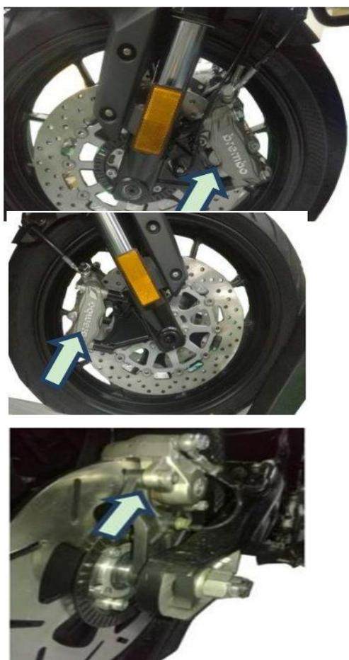
L'essentiel lors de la vérification des plaquettes de frein avant est de vérifier si elles sont usées jusqu'à la limite d'usure. Si elles dépassent cette limite, elles doivent être remplacées par des plaquettes neuves.
