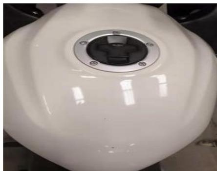
Pour ouvrir le bouchon du réservoir, insérez la clé et tournez-la de 90 degrés dans le sens des aiguilles d'une montre, puis retirez le bouchon à l'aide de la clé. Insérez la clé lors de la pose du bouchon, tournez-la de 90 degrés dans le sens des aiguilles d'une montre, appuyez fermement sur le bouchon et relâchez-la clé. Enfin, retirez la clé.
