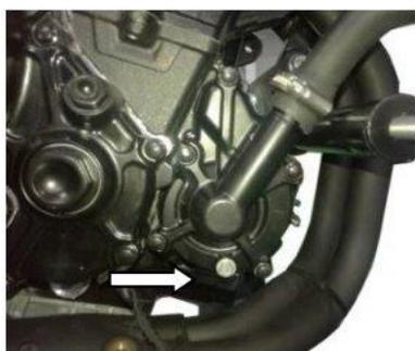
Pour vidanger l'antigel proprement, utilisez un pistolet à air comprimé pour presser l'air comprimé de l'orifice du radiateur dans le système de refroidissement jusqu'à ce que l'antigel s'écoule proprement.
