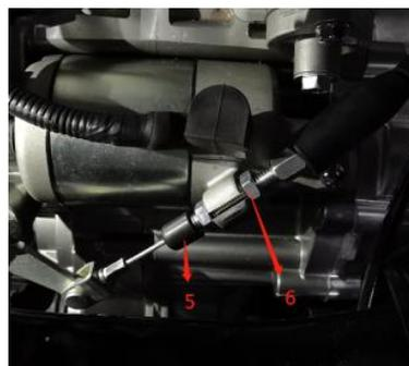
Desserrez l'écrou ②. Tournez la bague de réglage de la tension de la poignée ③ et tournez-la dans le sens des aiguilles d'une montre jusqu'au bout. Desserrez le contre-écrou ⑥ de la bague de réglage de la corde, puis tournez la bague de réglage de la tension de la corde ⑤ d'avant en arrière, de sorte que l'espace entre les poignées soit d'environ 4 mm. Après avoir ajusté la tension de la poignée ③, serrez simultanément les contre-écrous ② et ⑥ et placez la gaine ④.
