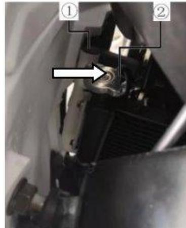
2. Ajoutez de l'antigel par l'ouverture du sous-réservoir de sorte que le niveau soit au-dessus de la ligne L et en dessous de la ligne F.
